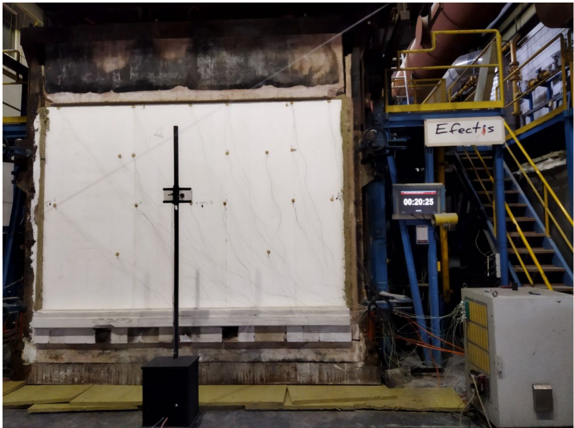
Foto C. 15: Probe nach 20 Minuten Erhitzung
